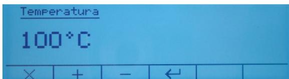
La temperatura impostata di default è 100°C, utilizzare i tasti **+** **-** per incrementare o decrementare il valore. Tenendo premuto a lungo il tasto il valore viene incrementato o decrementato velocemente.
