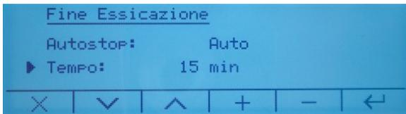
La durata del ciclo impostata di default è pari a 15min, utilizzare i tasti **+** **|** **-** per incrementare o decrementare il valore. Tenendo premuto a lungo il tasto il valore viene incrementato o decrementato velocemente.
