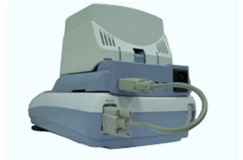
**Inserire** il cavo VDE in dotazione nel connettore di alimentazione posto sul retro dello strumento.
