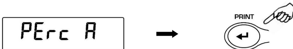
3. Se realizará la tara y la pantalla mostrará el mensaje “Load”. Cargar el peso de referencia sobre el plato y pulsar **PRINT**, el mensaje “Load” parpadeará una vez y después de haber adquirido el peso se mostrará el valor con la indicación del %
