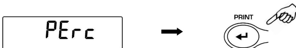
2. Seleccionar la función “**Perc M**” presionando **MENU** y confirmar con **PRINT**.
