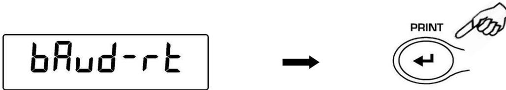
2. Die serielle Datenübertragungsgeschwindigkeit (1200-2400-4800-9600 Baud) wählen. Durch Drücken der Taste **MENU** oder **CAL** kann man durch die unterschiedlichen Geschwindigkeiten vor- oder rückwärts scrollen und dann mit Taste **PRINT** die Wahl bestätigen
