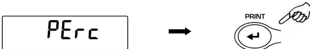
2. Mit der Taste **MENU** die Funktion "**Perc M**" wählen und mit Taste **PRINT** bestätigen.
