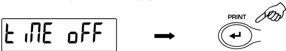
2. Puis, en appuyant sur la touche **MENU** ou **CAL**, il est possible de faire défiler les différents modes d'extinction automatique en avant ou en arrière, sélectionnez le mode désiré et appuyez sur **PRINT** pour confirmer.
