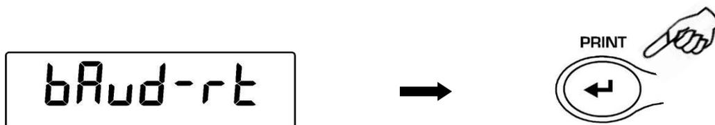
2. Sélectionnez la vitesse de transmission des données sérielles (1200-2400-4800-9600 baud). En appuyant sur la touche **MENU** ou **CAL**, il est possible de faire défiler les différentes vitesses de transmission en avant et en arrière, confirmez votre choix en appuyant sur la touche **PRINT**.
