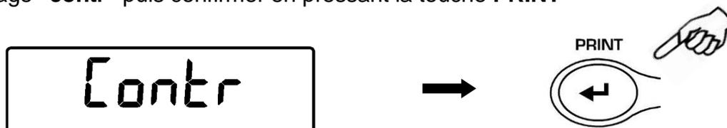
2. En pressant la touche **MENU** ou **CAL** il sera possible d'augmenter ou de diminuer le niveau de contraste de l'afficheur, sélectionner celui désiré et confirmer avec la touche **PRINT**
