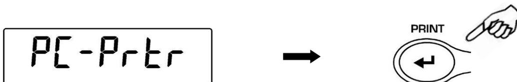
2. Para selecionar o modo de impressão pressionar a tecla **MENU** até visualizar a palavra “PRINT” ou “TLP50” se você deseja se conectar a impressora TLP50 para imprimir em etiquetas papel contínuo com a data ea hora
