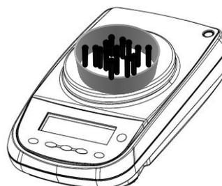
Se o peso da amostra for ainda insuficiente será exibida a palavra “**Add SMP**”. Acrescentar uma quantidade de peças, de modo a dobrar a quantidade exibida no mostrador.
