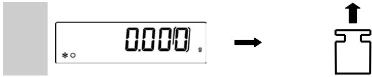
Tramite la funzione **LOAD** della bilancia, è inoltre possibile calibrare la bilancia con un peso di calibrazione superiore al peso di calibrazione preimpostato in fabbrica:
