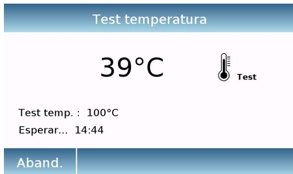
Tras haber iniciado la prueba, esperar a que el cronómetro configurado en automático de 15 minutos llegue a cero. Se emitirá una señal acústica, abrir el calefactor y comparar el valor de temperatura visualizado en la pantalla con el marcado por el termómetro situado en el interior.
