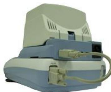
**Introducir** el cable VDE proporcionado en el conector de alimentación situado en la parte trasera del aparato.
