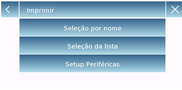
**Imprimir:** a função de impressão permite imprimir em papel ou em um arquivo de programa de secagem, digitando o nome ou selecionando-o a de uma lista.
