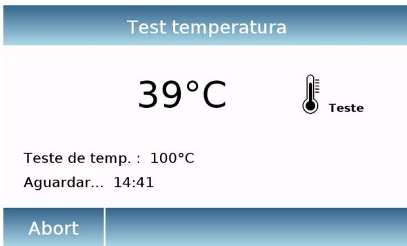
Depois de iniciar o Teste aguarde que o temporizador configurado em automático para 15 minutos seja restaurado. Será emitido um sinal sonoro, abra o aquecedor e compare o valor de temperatura exibido no monitor com o detectado pelo termômetro interno.
