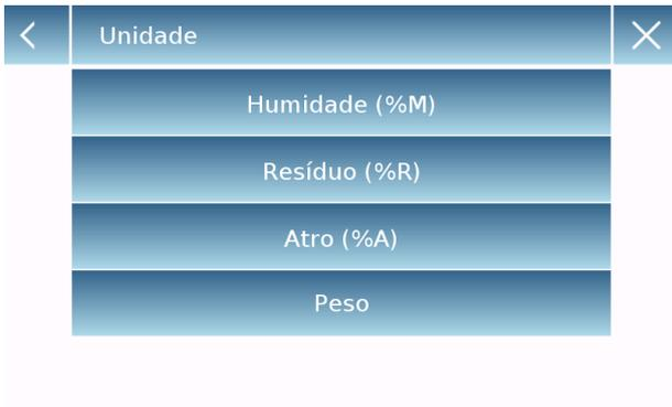
**Unidade:** esta função permite seleccionar o parâmetro com o qual exibir o ciclo de secagem
