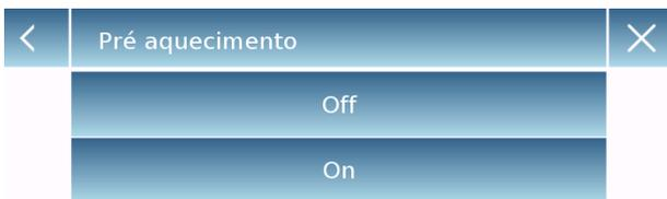
**Pré-aquecimento:** esta função permite efetuar o pré-aquecer do aquecedor antes de efetuar um ciclo de secagem.
