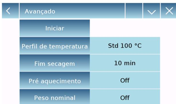
A página exibida permite iniciar um ciclo de secagem tocando na tecla "Iniciar" com os parâmetros de temperatura e as modos de fim de secagem exibidos à direita da função.
