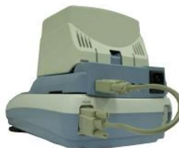
**Ligue** o cabo VDE fornecido no conector de alimentação na parte posterior do instrumento.
