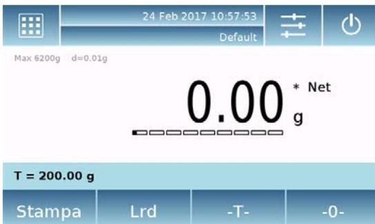
Sul display il simbolo **Net** indica il peso netto. Utilizzando il tasto **"Net"** è possibile passare alla visualizzazione del peso lordo **"Lrd"**. La scritta **"T= "** indica il valore della tara acquisita.
