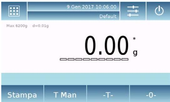
Nella schermata di pesatura semplice, nell'area di indicazione peso viene visualizzato il valore del peso caricato sul piatto di pesata.
