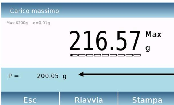
Una volta raggiunto il carico di rottura del campione sotto test sul display viene visualizzato il valore massimo di peso raggiunto.
