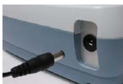
**Inserire** il jack dell'alimentatore in dotazione nel connettore posto sul retro dello strumento.
