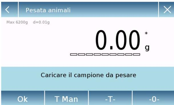
Eseguire se necessario l'azzeramento dell'indicazione o caricare l'eventuale tara. Caricare il campione da analizzare e toccare il tasto “**Ok**”
