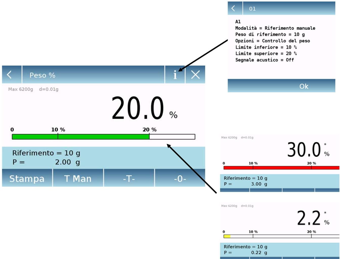
La barra relativa al controllo del peso è di colore giallo quando il peso caricato è inferiore alla soglia minima, verde quando il peso è all'interno dell'intervallo impostato (con indicazione del segnale acustico se attivato) e rossa quando il peso è superiore alla soglia superiore impostata.
